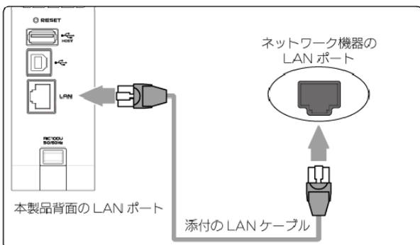
**注意** ●必ず、LAN ケーブルを先に接続してください。LAN ケーブルを接続する前に本製品の電源を入れると、正しくネットワークに参加できなくなります。
